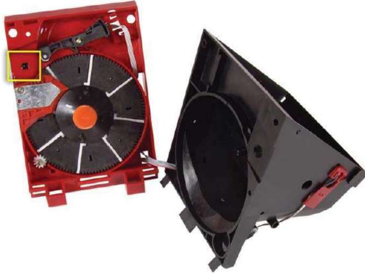
Figura 27. Limpieza Hopper U-II
