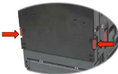
Figura 5: Apertura de la compuerta del Note Float
